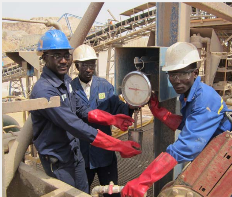
Formation sur la prise de densité à la sortie du broyeur, Samira Hill, Niger
